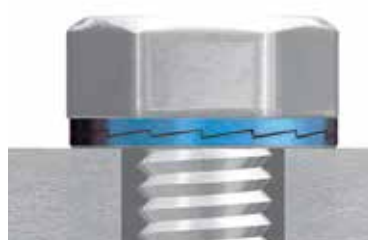
Klíny podložek uzavřeny – správně
