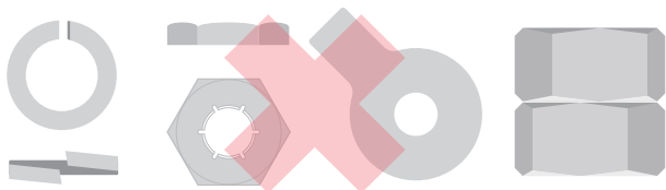
zajišťovací prvky nesplňující požadavky
